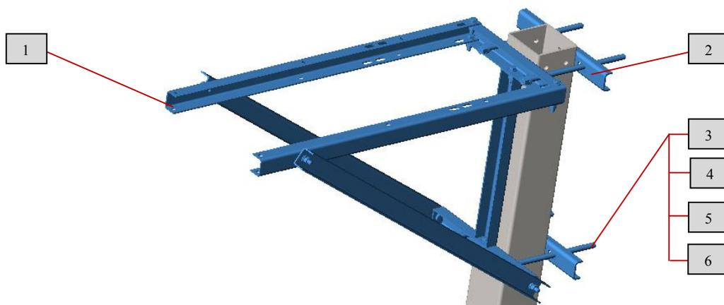
Рис. 59 Крепление монтажного комплекта разъединителя стойки с ТСН
